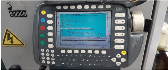
Рис. 4. Пульт управления роботом KUKA KR 210
